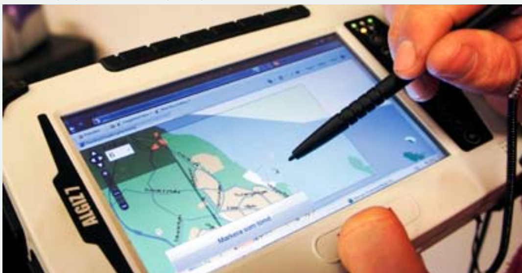
Datorm är fukt- och stöttålig och har en tryckkänslig skärm. De knappar och symboler som används i kartan är anpassade för att kunna hanteras i fält genom att peka på skärmen med ett finger.
