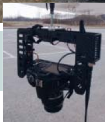
Kameran är fästad under ballongen och kan rotera och luta för önskad bild.
